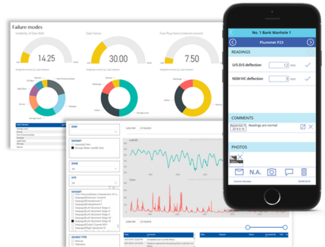
La solución multiplataforma DamGuard facilita la supervisión de la seguridad de las presas
